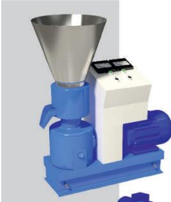
Мини пресс-гранулятор ДГ-0.3Н mini предназначен для гранулирования комбикорма, зерносмесей и кормовых материалов. Гранулятор ДГ-0.3Н mini позволяет быстро и с минимальными затратами организовать производство гранул в условиях хозяйства и получать высококачественный гранулированный комбикорм, сравнимый по качеству с производимым на больших промышленных пресс-грануляторах.
