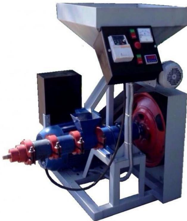
Экструдеры предназначены для изготовления очень качественного корма путем экструзии переработанного фуражного зерна – это может быть как пшеница, так и рожь, соя, ячмень, горох или кукуруза. В зерновой экструдер в изготавливаемый экструдированный корм добавляется также хвоя, солома и даже камыш.
