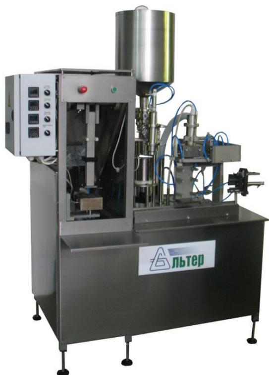
**ОПИСАНИЕ:** Предназначен для розлива и герметичной упаковки жидких и пастообразных продуктов (цельномолочные, кисломолочные, фруктовые напитки, соки и т.д.) в картонный пакет с двухсторонним полиэтиленовым покрытием (упаковка Пюр-Пак, тиа «А» или тип «В») и фольгированный картонный пакет (упаковка Пюр-Пак асептик, тип «А» или тип «В») емкостью от 250 до 1000 мл. С последующей маркировкой и автоматической выдачей упакованного продукта. Обслуживание полуавтомата производится одним оператором.
