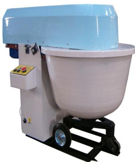
**Назначение:** машины тестомесильные марки ТММ-140 и ТММ-330 предназначены для замешивания теста из пшеничной и ржаной муки влажностью не менее 33% для ТММ-140 и не менее 35% для ТММ-330 в не вращающихся подкатных дежах вместимостью 140, 330 литров соответственно.
